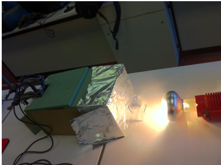
Figuur 22: camera obscura die voor een convergerende lens staat met daarvoor een warme lamp
